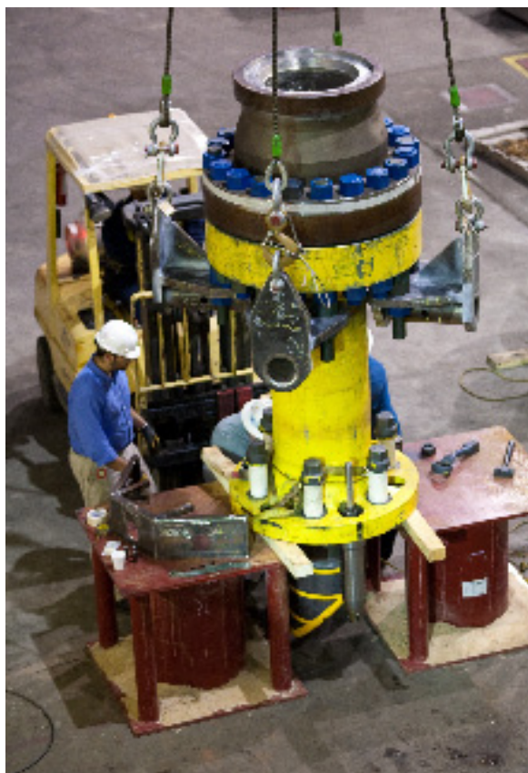
为了防止漏油事件再次发生，Xerafy 的合作伙伴 Holland 1916 正在给 BP 石油的吊钩安装 RFID 标签
